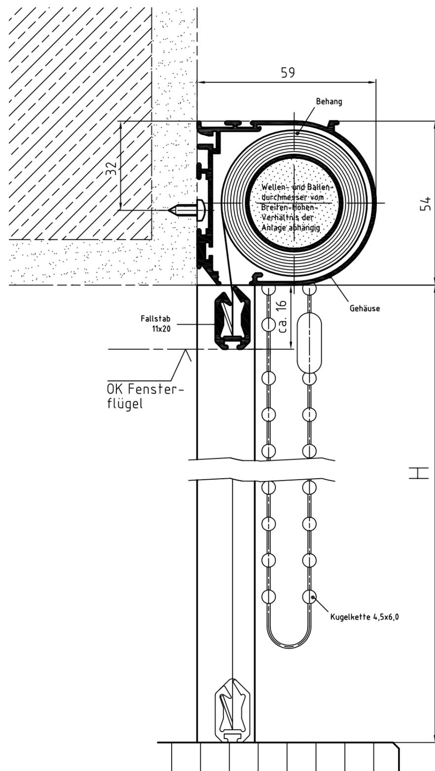
Zeichnung L-KR 60 – Längsschnitt Systemskizze | ohne Maßstab | sämtliche Angaben in mm
