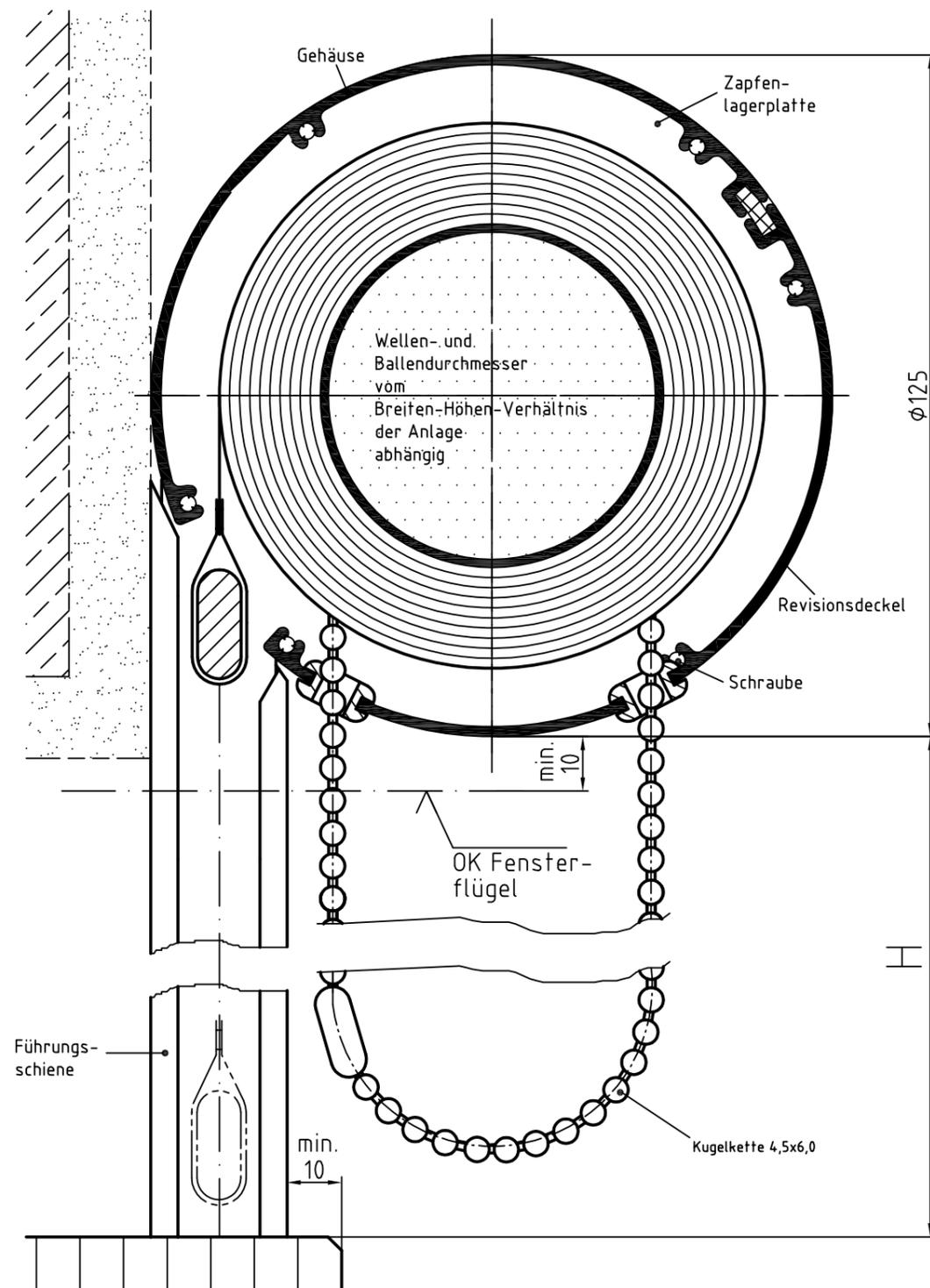
Zeichnung L-KR 125 – Längsschnitt Systemskizze | ohne Maßstab | sämtliche Angaben in mm
